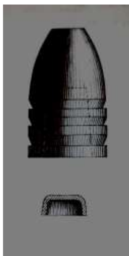
Illustration 8: Manceauxprojektil med culot
